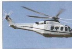
Helikoptera lāpstīņas rada cēlējspēku un vilcējspēku.
